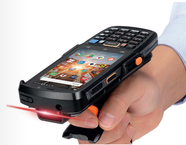
Exempel på en handhållen skanner med pistolgrepp.
